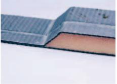
Figure 4: Deck Panel Edge Detail
