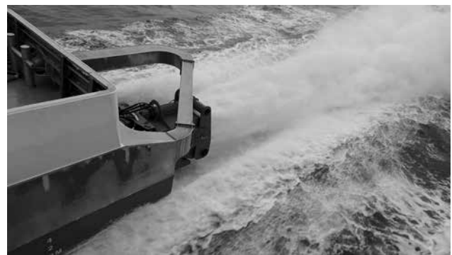
A Wärtsilä waterjet at work in Francisco (Photo courtesy Wärtsilä)
